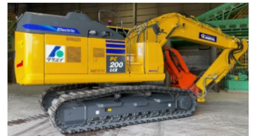
電動重機を試験導入
