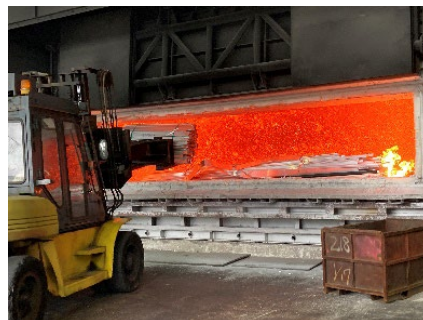
溶融炉投入状況
