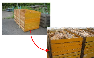
型枠廃材にて加工場のゴミ箱を製作
